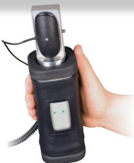
Le calibrage sur site nécessite l'utilisation du calibre vibratoire SV 111 afin de réaliser la vérification du calibrage de l'instrument avant et après une ou plusieurs mesure(s). Pour cette procédure, l'accéléromètre SV 107 est installé sur l'excitateur de calibrage à l'aide de l'adaptateur SA 105A. Le calibre génère un signal de  $10 m/s^2$  à 80 Hz, La durée de calibrage est de 30 secondes pour chaque axe.
