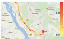
La norme ISO 2631-1 indique qu'il est souhaitable que le rapport de mesure donne toute information relative aux changements de conditions pendant la mesure. Le SV 100A permet la corrélation entre données GPS et vibratoires en les marquant sur une carte, la couleur indiquant les amplitudes de vibration. Cette solution représente un outil puissant d'analyse de l'exposition quotidienne A(8) en corrélation avec la vitesse du véhicule et les conditions de route.
