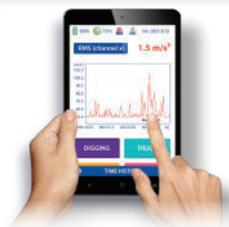
L'interface communication sans fil (BT) du SV 100A permet de voir sur téléphone ou tablette les résultats via notre application. L'application envoie également une alarme quand les limites prédéfinies d'exposition vibratoires sont dépassées.
