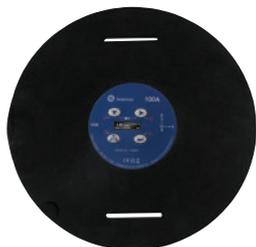
Le SV 100A mesure l'exposition vibratoire A(8) et la valeur totale d'exposition (VECTEUR) Selon la norme ISO 2631-1 et Directive UE 2002/44/EC. Le résultat A(8) est donné en  $m/s^2$  (RMS),  $m/s^{1.75}$  (VDV) et points. Le SV 100A surveille la durée restante avant limites et informe quand les limites sont atteintes.
